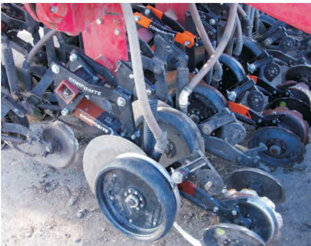
Рис. 4. Расположение экспериментальных сошников на посевном комплексе Agro-Союз Turbosem II 19-60 (выделены цветом)
