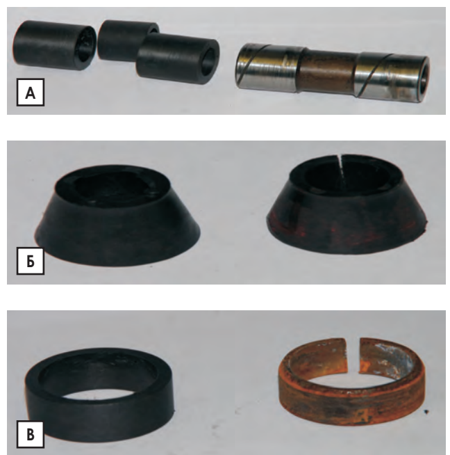
Рис. 3. Общий вид экспериментальных и серийных деталей: А – детали нижнего параллелограмма (рис. 1, №2); Б – конические втулки (рис. 1, №3); втулки разрезные (рис. 1, №4, 5)
